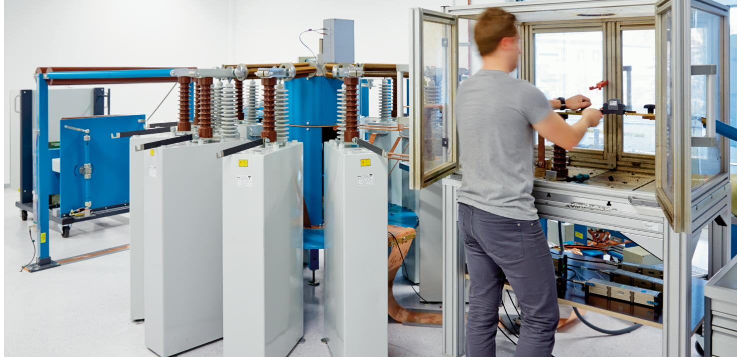
В нашей собственной сертифицированной лаборатории импульсного и многоамперного тока устройства защиты от импульсных перенапряжений подвергаются многочисленным проверкам и испытаниям на этапе разработки.
